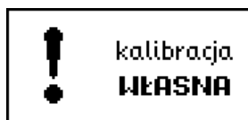
Rys.18. Komunikat o przymusowym ustawieniu kalibracji „WŁASNEJ” (brak kalibracji „URZĘDU”).
