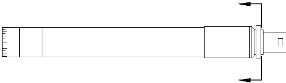
Rys. 4.1. Sposób odłączania przedwzmacniacza ze złączem LEMO.
