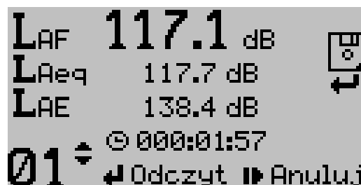
Rys. 3.10. Odczyt pomiaru z pamięci.
