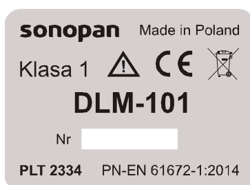
Rys. 1.3. Miernik poziomu dźwięku DLM-101 - tabliczka znamionowa.
