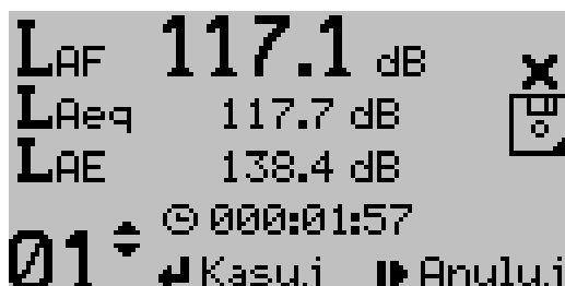
Rys. 3.11. Kasowanie pomiaru w pamięci.
