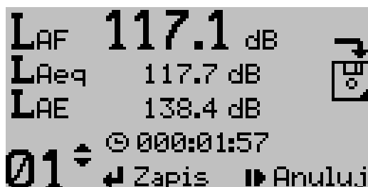
Rys. 3.9. Zapis pomiaru do pamięci.
