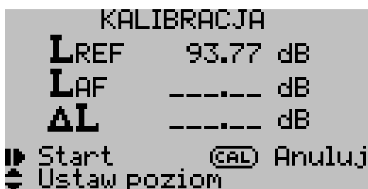
Rys. 3.17. Kalibracja - wpisanie poziomu referencyjnego.
