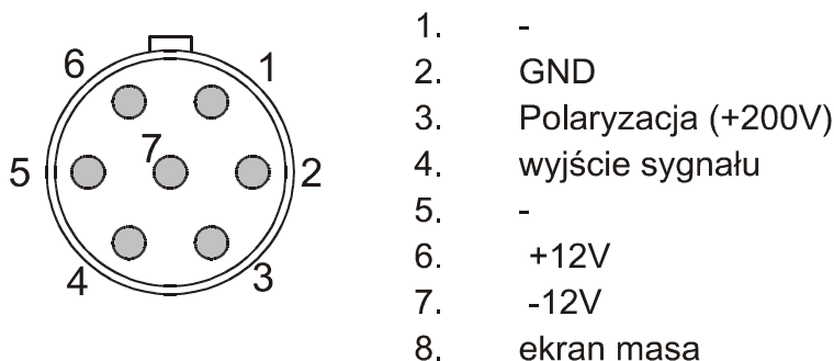
Rys. 4. Wtyk LEMO - widok od strony styków.
