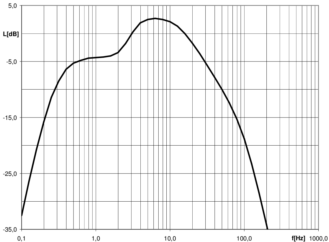
Rys. A.11. Charakterystyka filtru W_k dla drgań ogólnych pionowych, oś Z, osoba siedząca, stojąca lub leżąca, według ISO 2631-1, zgodnego z PN-EN ISO 8041:2008.
