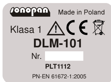
Rys. 1.2. Miernik poziomu dźwięku DLM-101 - tabliczka znamionowa.
