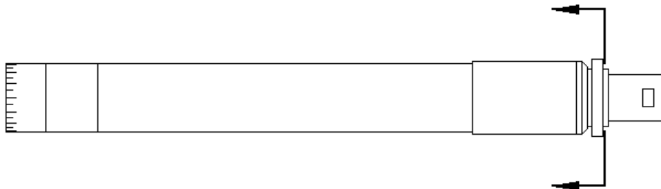
Rys. 4.1. Sposób odłączania przedwzmacniacza ze złączem LEMO.
