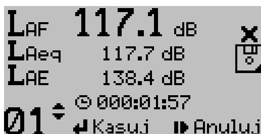
Rys. 3.11. Kasowanie pomiaru w pamięci.
