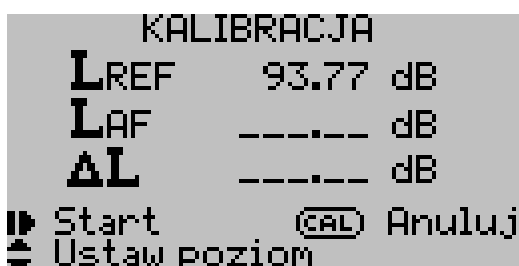
Rys. 3.17. Kalibracja - wpisanie poziomu referencyjnego.
