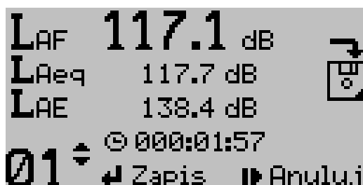
Rys. 3.9. Zapis pomiaru do pamięci.
