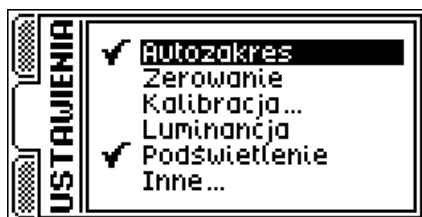
Rys.5. Zakładka menu USTAWIENIA z ustawionymi opcjami automatycznej zmiany zakresu pomiarowego i podświetlenia ekranu.
